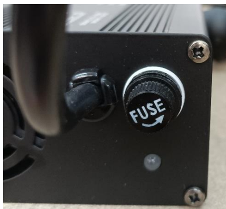
Fusible de protección
